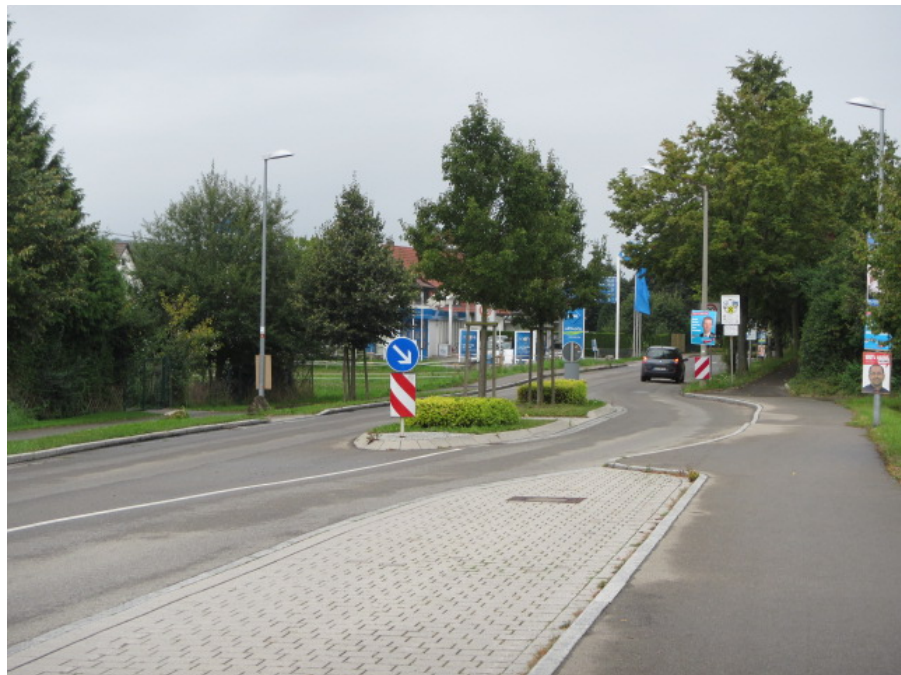
Abb. 7-6: Beispiel für eine Querungshilfe in der Ortseinfahrt (Renningen, Leonberger Straße)
